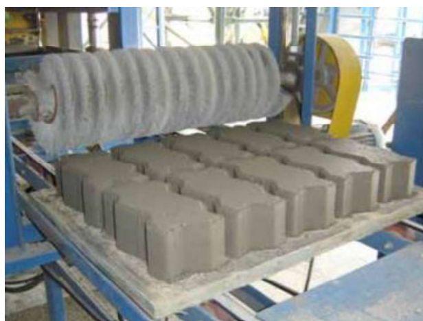
Figura 4 – Produção de paver por vibro-prensa hidráulica.
