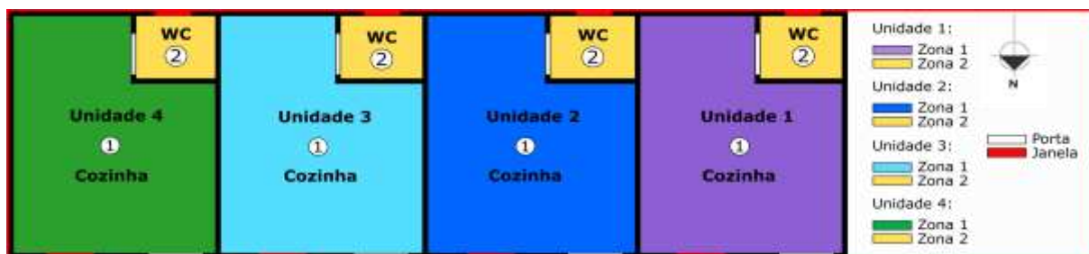
Figura 3 – Planta baixa da edificação
