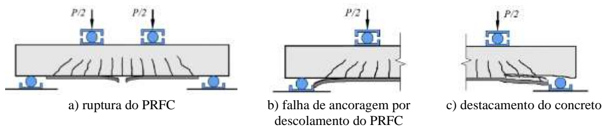
Figura 2 – Modos de ruptura de vigas de concreto armado reforçadas à flexão com PRFC.
